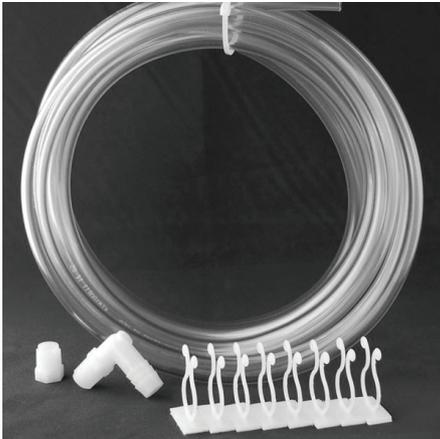
**Beschreibung:** Flexible Vinylschlauch zur Verteilung von kalter Luft oder zur gezielten Führung auf Hot Spots. Schlauchverbinder, Endstopfen und Klebeclips, um den Schlauch zu befestigen sind enthalten. Löcher können gebohrt oder in den Schlauch geschnitten werden ("V" geformt). Wenn der Endstopfen verwendet wird, müssen mindestens 6 3,2 mm Durchmesser Bohrungen gemacht werden, um einen übermäßigen Rückdruck auf den Kühler zu vermeiden.
